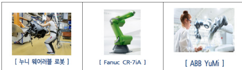
[그림 4-8] 인간과 협력이 가능한 제조용 협업 로봇 예시
